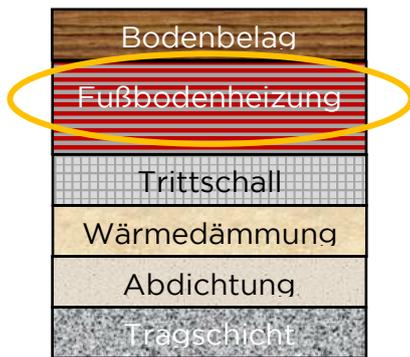
Der herkömmliche Fußbodenaufbau inklusive Fußbodenheizung hat eine Dicke von 92mm. Die Heizelemente allein sind 62mm dick und bestehen aus einer Vielzahl an Komponenten.
