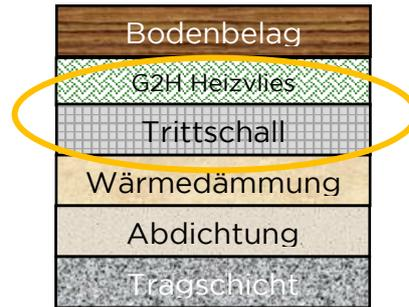
Das leitfähige, langlebige Heizvlies mit einer Stärke von 2mm, einer Dichte von **100 kg/m<sup>3</sup>** und einer Wärmeleistung bis 80 W ist nach einem patentrechtlichen Verfahren hergestellt und besteht aus **100% recyceltem Polyester**. Es eignet sich ideal für die Temperierung von Fußböden, Wänden und Decken.
