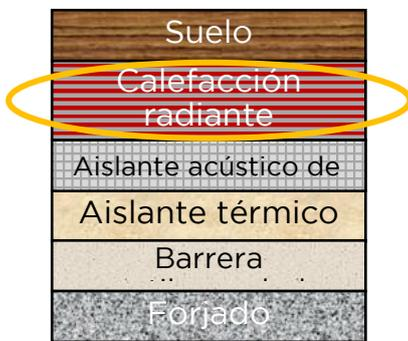
La construcción convencional del suelo, incluida la calefacción por suelo radiante, tiene un espesor de 92 mm. Los elementos calefactores por si solos tienen un grosor de 62 mm y constan de una variedad de componentes
