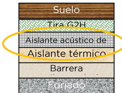
La tira calefactora g2h duradera, con un grosor de 2 mm, una densidad de 100 kg/m<sup>3</sup> y una potencia calorífica de hasta 80 W/m<sup>2</sup>, se fabrica mediante un proceso patentado y está compuesto de poliéster 100% reciclado. Es ideal para el control de temperatura de suelos, paredes y techos".
