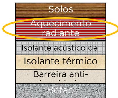
A construção convencional do pavimento, incluindo o piso radiante, tem uma espessura de 92 mm. Só os elementos de aquecimento têm 62 mm de espessura e consistem numa variedade de componentes
