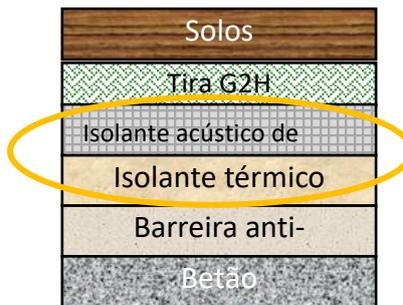
A tira de aquecimento durável g2h, com uma espessura de 2 mm, uma densidade de 100 kg/m<sup>3</sup> e uma potência de aquecimento de até 80 W/m<sup>2</sup>, é fabricada através de um processo patenteado e é composta por poliéster 100% reciclado. É ideal para o controlo da temperatura de pavimentos, paredes e tetos."
