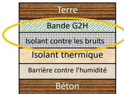
La bande chauffante durable g2h, d'une épaisseur de 2 mm, d'une densité de 100 kg/m<sup>3</sup> et d'une puissance calorifique allant jusqu'à 80 W/m<sup>2</sup>, est fabriquée selon un procédé breveté et est composée à 100 % de polyester recyclé. Elle est idéale pour le contrôle de la température des sols, des murs et des plafonds.
