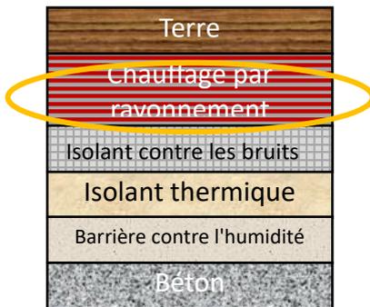
La structure de sol conventionnelle, y compris le chauffage au sol, a une épaisseur d'environ 92 mm. La couche chauffante, à elle seule, a une épaisseur de 62 mm et se compose de divers éléments
